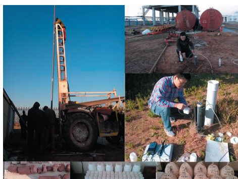
神华碳封存场地地下水和土壤气分层取样现场
