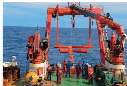
科考队员进行深海潜标玻璃浮球和声学释放器的回收
