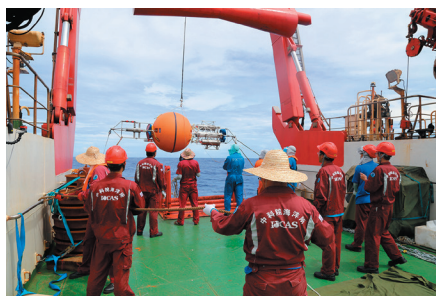
科考队员进行深海潜标观测设备和数据实时化通信设备的布放
