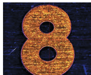
放大镜下 PCB 膜去除效果
