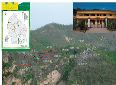
延安羊圈沟辅站样点-小区-坡面-流域尺度生态水文过程监测系统
