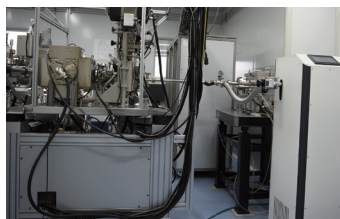
固定波长 DUV/VUV-DPL 用于深紫外激光光发射电子显微镜
