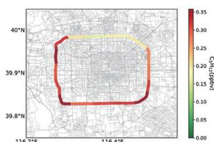
(1) 北京市大气污染物监测 成功应用于北京四环、五环路周边挥发性有机物 (VOCs) 的车载移动监测，为大气污染物的分布及溯源提供可靠数据。
