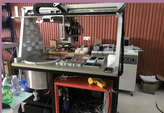
超微量 DNA 自动提取检测工作站仪器 plus 机内部实物图
