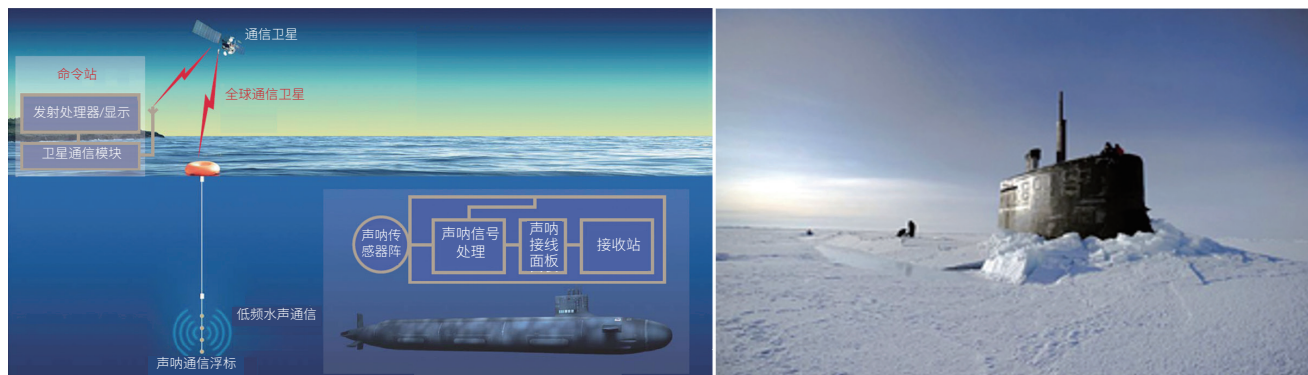
图3 Deep Siren 低频远程水声通信系统浮标工作示意图
