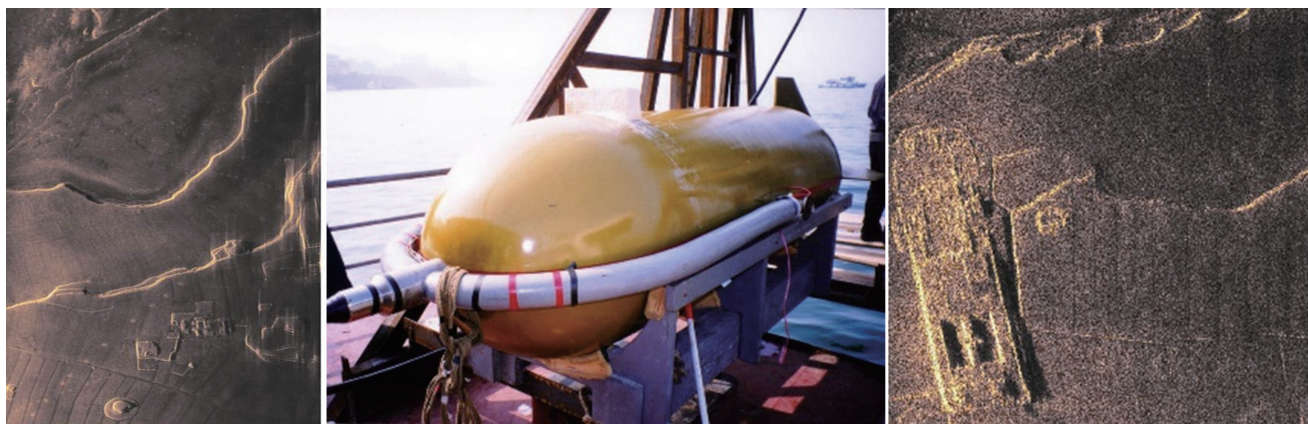
图 3 合成孔径声呐（SAS）所获得的高分辨率海底/沉船图像（中国科学院声学所研制）
