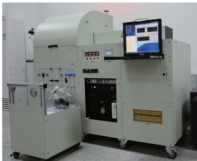
人体超极化 ^{129}\text{Xe} 气体系统工作实物图
