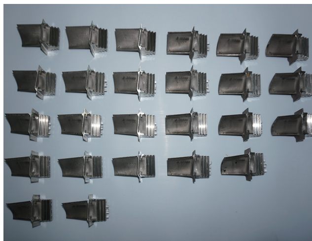
图6 批量加工的某型号单晶涡轮叶片
