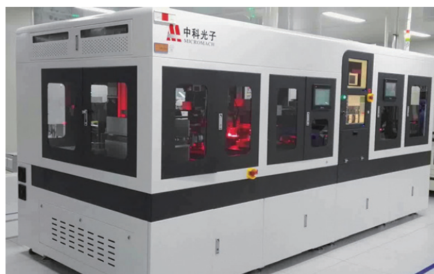
图 9 指纹模块切割智能化全套生产线
