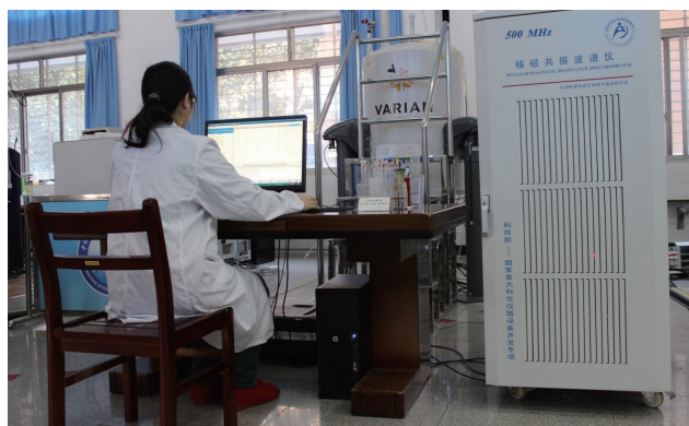
图 9 500 MHz 核磁共振波谱仪
