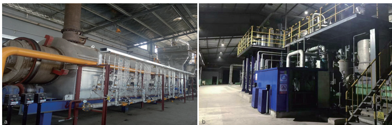
图3 中国自主研发的年产万吨秸秆生物质炭生产集成系统
