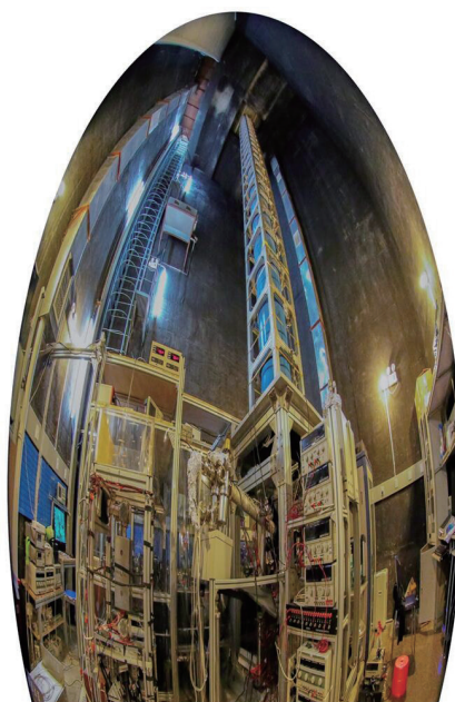
图4 十米喷泉式原子干涉仪（实际高度为12 m）
