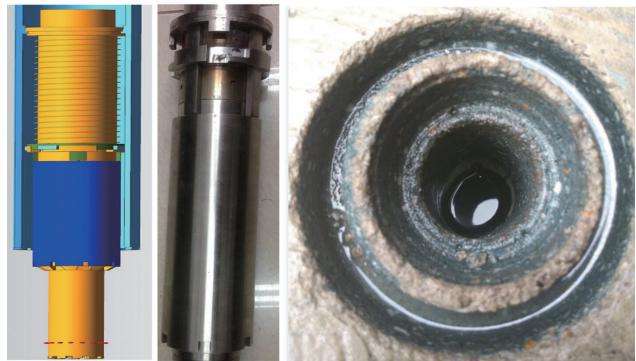
图12 钻测一体化连接部件及钻进测试试验结果
