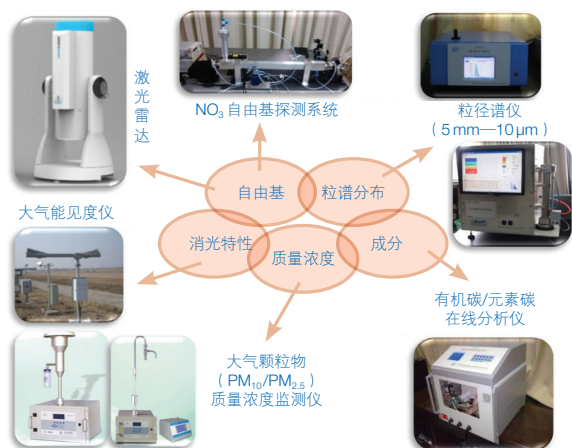
图4 大气细颗粒物在线监测系统
