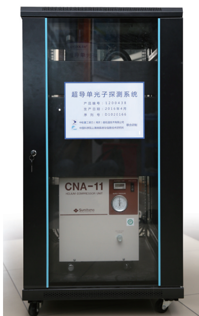
图2 SNSPD 超导单光子探测系统
