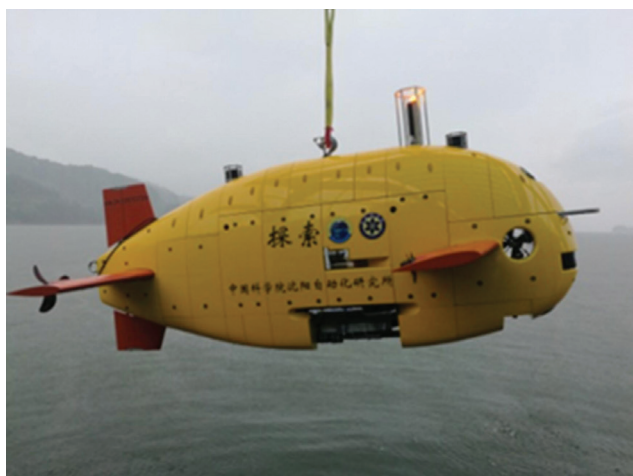
图5 4500 m 级深海热液探测 AUV 系统
