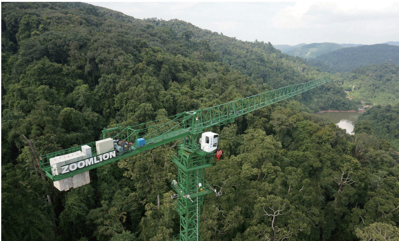
西双版纳热带雨林森林塔吊观测系统，塔吊工作高度81 m，伸臂工作长度60 m，伸臂旋转幅度大于360°
