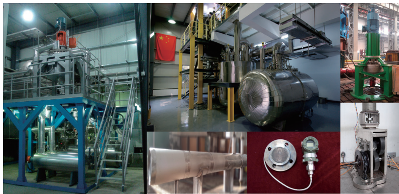
大型熔盐实验回路与关键设备样机
