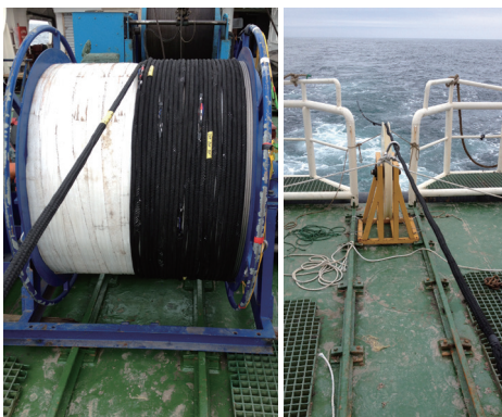
图4 绞车、导向滑轮实物图及海试状态示意图
