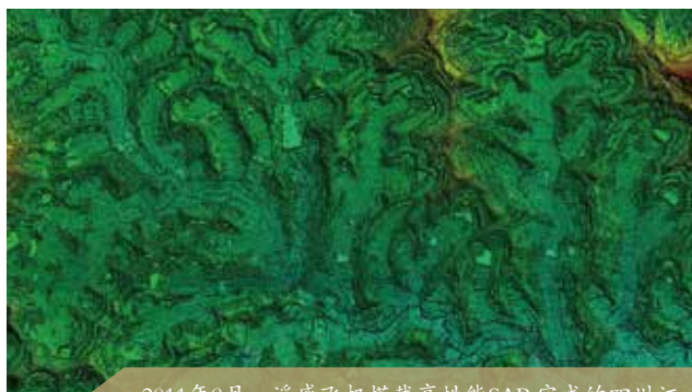
2011年8月，遥感飞机搭载高性能SAR完成的四川江油正射图像及数字高程模型产品
