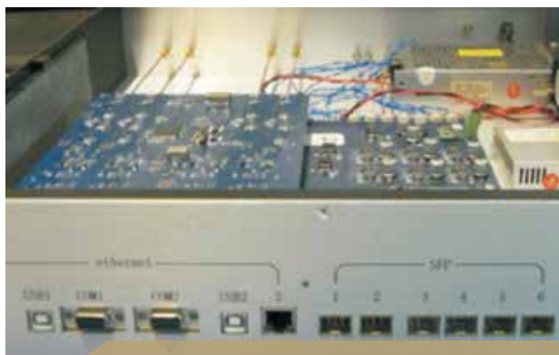
SSRF 数字化束流位置信号处理器 BPM
