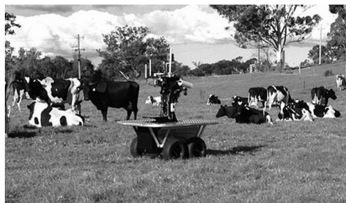
图3 牧羊犬机器人
