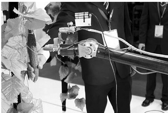
图6 摘黄瓜机器人
