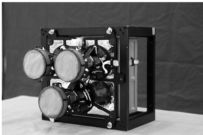
图12 多波段紫外临边成像仪的环形光谱成像仪
