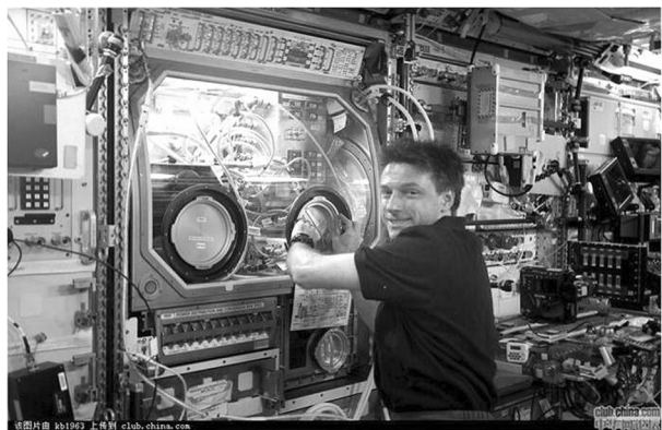
图6 国际空间站(ISS)上的科学手套箱,用于开展生命科学实验和其他科学实验
