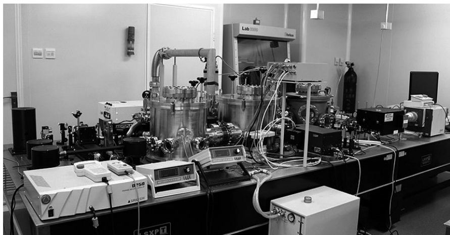
图 深紫外激光光化学反应仪与在线检测系统
