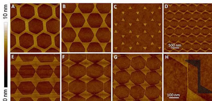
以这种方法制备出的 10 纳米以下宽度石墨烯纳米带为基本研究对象,他们对其输运性质及拉曼散射进行了研究。实验结果表明:在这种锯齿形边缘结构的石墨烯纳米条带中,载流子在其边缘散射很弱,从而导致其具有极高的载流子迁移率。相对于其他方法制备的同等宽度的边缘结构无序的纳米条带,载流子迁移率高出一个量级。这种高质量的石墨烯纳米结构是制作高速电子学器件的理想材料。另外,和以往无需边缘结构的石墨烯纳米条带的输运特性不同,他们在实验上首次观察到由于锯齿形边缘态导致的半金属性输运行为。这种具有锯齿形边缘的 10 纳米以下宽度石墨烯纳米带表现出与大片石墨烯类似的电输运性质,在室温下没有可观测的输运带隙。这些试验结果验证了以前的理论预言,表明 zigzag 石墨烯纳米条带确实是半金属的,澄清了边缘无序态会导致的输运能隙的打开这一现象。该成果发表在 *Adv. Mater.* 上。
