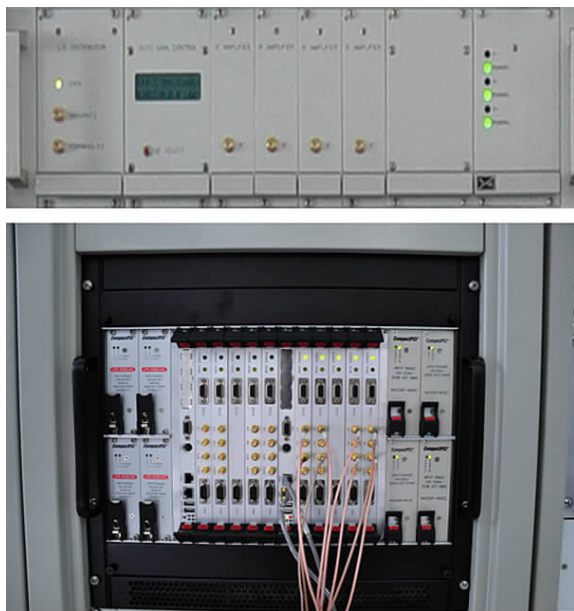
VLBI 数字基带转换器模拟部分(上)和数字部分(下)
