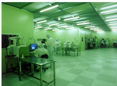
上海新傲高科技公司的 10 级超净 SOI 圆片生产线
