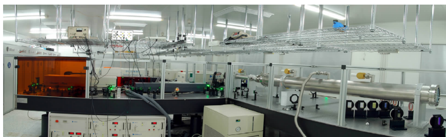
建造了台面 350TW 掺钛蓝宝石飞秒超强激光装置
