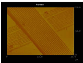
256 位分子存储器的原子力显微镜照片
