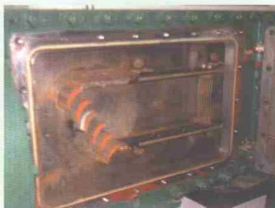
激波管风洞涡轮叶栅实验台
