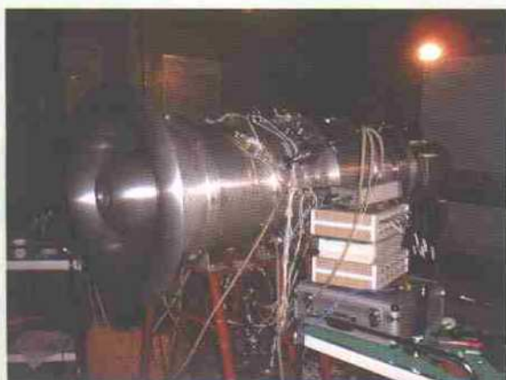
三级轴流压气机实验台
